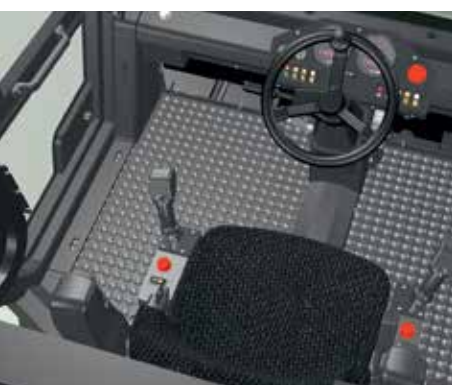
Эргономичность: Два рычага управления с обеих сторон сиденья для комфортной работы
